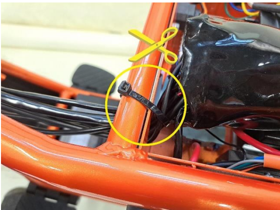
Katkaise johtosarjaa kannatteleva nippuside.
