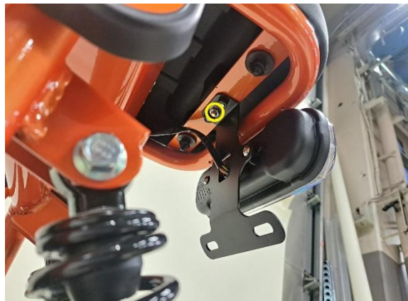
Irrota istuimen kiinnitysmutteri (kiintoavain 10 mm).
